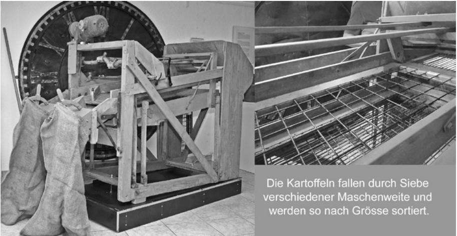
Die Kartoffeln fallen durch Siebe verschiedener Maschenweite und werden so nach Grösse sortiert.
