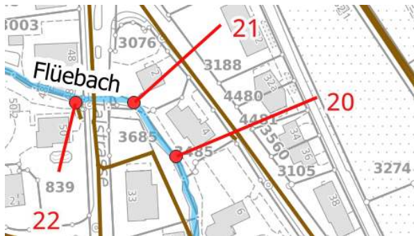
20: Einleitung von entlastetem Mischabwasser vom AVL-Kanal (Entlastung RA2). Einleitstelle nicht zugänglich.
