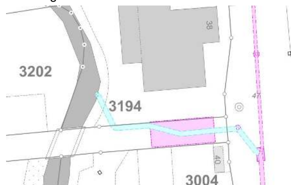
25: Einleitung von entlastetem Mischabwasser vom AVL-Kanal (Entlastung RAZ49 über RKB Flüh). Einleitstelle nicht sichtbar aufgrund von dichtem Bewuchs.
