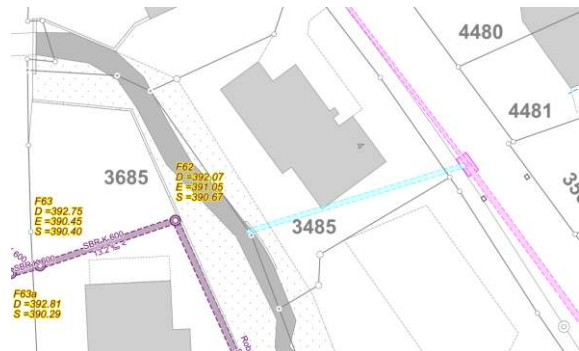
20: Einleitung von entlastetem Mischabwasser vom AVL-Kanal (Entlastung RA2). Einleitstelle nicht zugänglich.
