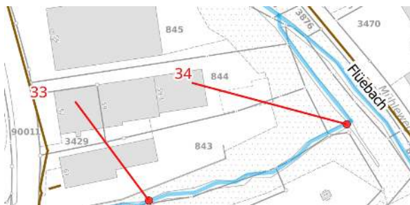
34: Einleitung von entlastetem Mischabwasser vom AVL-Kanal (Entlastung RA3). Einleitstelle nicht zugänglich.
